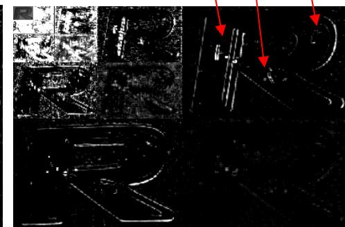
CDWTによりノイズ除去、欠陥鮮鋭化
